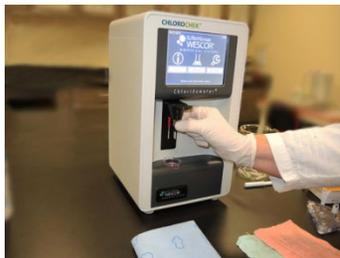
3. Remarquez l'angle de l'extrémité de l'électrode de mesure ci-dessous. Une fois que vous obtenez l'angle correct, tirez énergiquement sur les extrémités de l'électrode de mesure à travers le tissu en microfibres, en exerçant une forte pression vers le bas sur le tissu. Répétez l'opération pour tous les côtés de l'électrode. Si l'opération est réalisée correctement, des marques sombres apparaissent sur le tissu.
