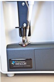
Ejectez complètement l'échantillon en enfonçant le piston de la pipette jusqu'au second cran, puis retirez le cône en maintenant le piston toujours enfoncé. Evitez de verser l'échantillon à proximité des électrodes ou des parois du bécher.
