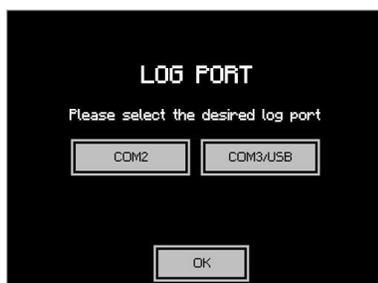
Pour utiliser le port RS232, sélectionner COM2 puis appuyer sur OK.
